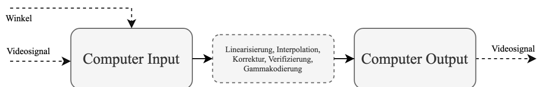
Abbildung 3.4: Schematische Darstellung des Computers-Abschnitts, der Methode zur Farbkorrektur
