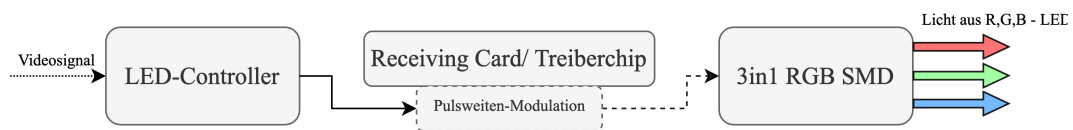
Abbildung 3.2: Schematische Darstellung einer LED-Wall: Videosegnal zu Lichtstrahlen
